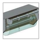
Le support de la bobine a été élargi pour pourvoir loger des bobines de film allant jusqu'à 250 mm 250 mm de diamètre : utile pour les films micro perforés pour l'emballage du pain.
